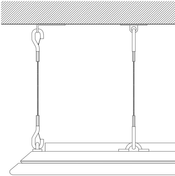
Zu allen Aufhängungssystemen gehören Sicherheitsdrähte, falls die Paneele mehr als 3000 mm über dem Boden an Wänden oder Decken installiert werden (optional für Drahtaufhängung).
