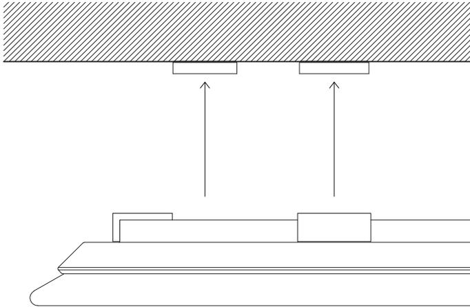
Ermöglicht das Abnehmen der Paneele ohne Werkzeug. Zur Montage an Wänden geeignet. Verdeckte Lösung.
