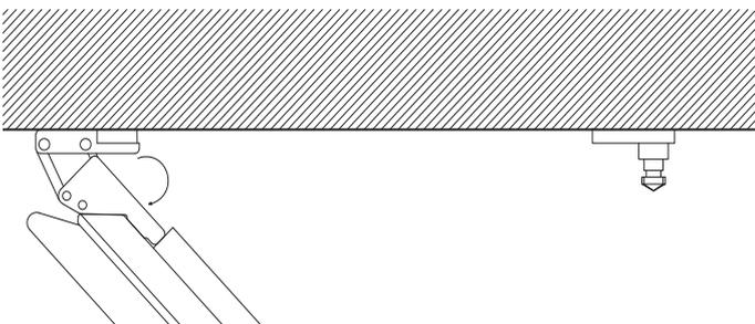
Wenn zu einem späteren Zeitpunkt Zugang hinter den Paneelen erforderlich ist, sollten die Soft Cells an Decken mit einer Scharnierverriegelung montiert werden.
